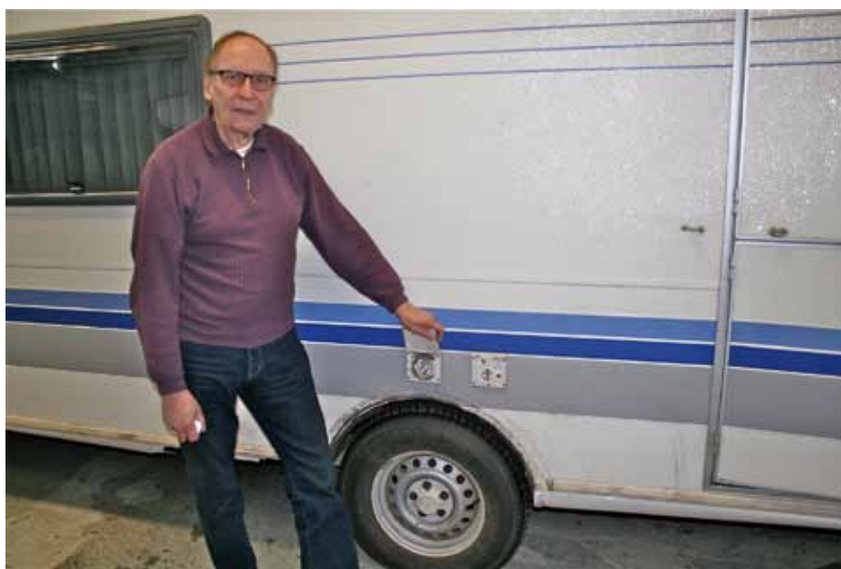
Rengasrikko voi vaurioittaa myös vaunun kylkeä ja siinä olevia sähkölaitteita
