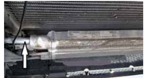
Lauhduttimen ylimmäinen korkeapaineletku vuoti
