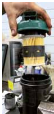
Uusi polttoainesuodatin laitetaan koteloon
