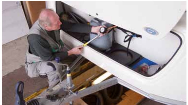
Matkailuajoneuvoasentaja Seppo Raatikainen koeponnistamassa kaasulaitteita.
