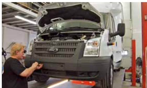
Lauri Kokkinen huoltotöissä. Huoltoa helpottamassa 6 000 kg nosturi alustahuoltoja varten.
